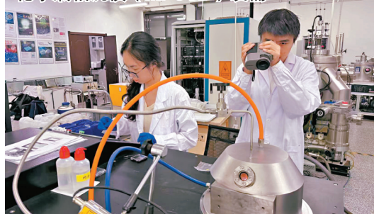
●哈工大團隊自主研製大功率微波等離子體化學氣相沉積（MPCVD）裝備。
